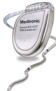
Extravascular implantable heart defibrillator (Aurora EV-ICD)
